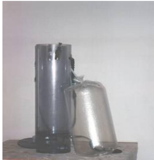
Abbildung 7-8: Probennahmegerät zur Geruchsmessung mit Probenbeutel
